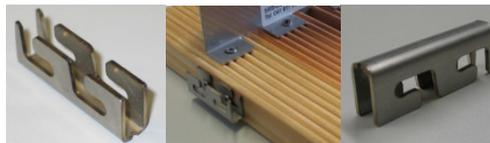
Mit dem SRS-Verbinder können die einzelnen Rostelemente clever miteinander verbunden werden. Der Verbinder ist von oben montierbar und hält die Elemente sicher als eine grosse Scheibe zusammen. Die als Schwalbenschwanz konzipierten Einfräsungen werden dabei über je 2 vorgängig gesetzte Schrauben eingeschoben womit der Verbinder einklickt. Der Verbinder kann jederzeit wieder von oben ausgehängt werden damit einzelne Elemente entfernt werden können
