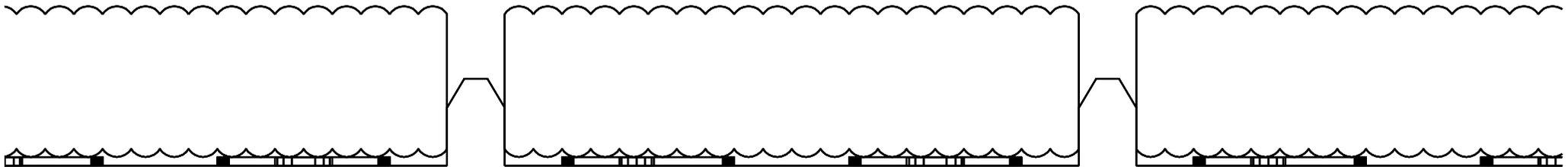
Rostprofil SRS-PN 50 mit Filzband direkt auf Untergrund verlegt
